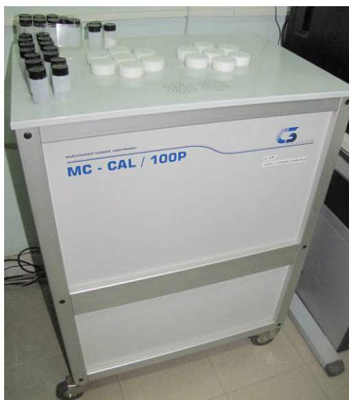
Slika 1 – Višekanalni cementni kalorimetar MC-CAL/100P
