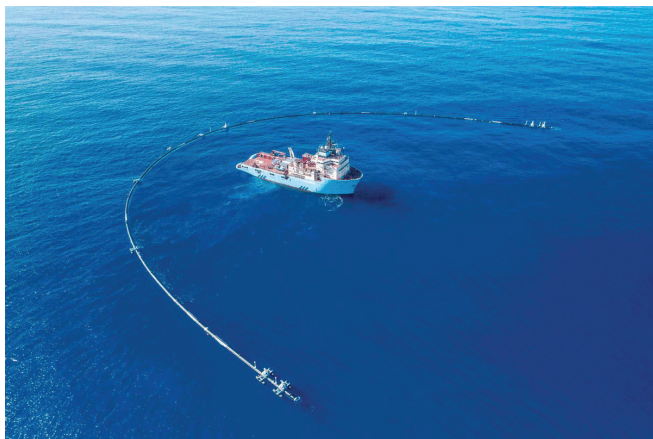
Slika 5 – Sustav za sakupljanje morskog makroplastičnog otpada prema rješenju "The Ocean Cleanup", autor Bojan Slat (Bojan Šlat) 17
