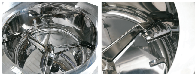
Slika 6 – Visoko-smični mikser, na desnoj slici uređaj za uzorkovanje (izvor: http://www.ima-pharma.com)
