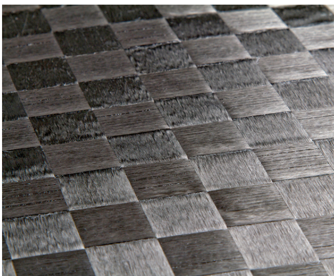
Slika 2 – TeXtreme® tkanina na osnovi ugljičnog vlakna
