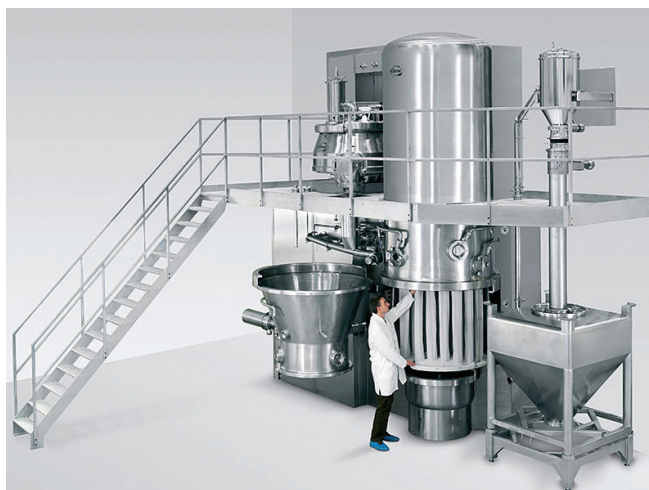
Slika 5 – Granulator za aglomeraciju u fluidiziranom sloju (izvor: www.servo-lift.com)
