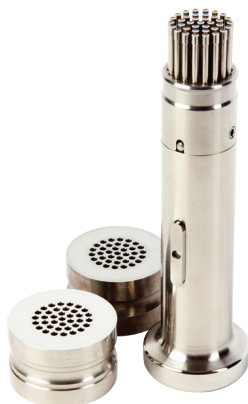
Slika 5 – EURO-D-441, Fette 37-tip kalupa za tablete promjera 2,25 mm. Kalup je izrađen od volframova karbida – tvrdog materijala, izrazito otpornog na trošenje. (izvor: http://www.ritter-pharmatechnik.com/en/ )
