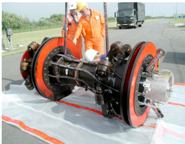
Slika 4 – Pig – uređaj za kontrolu cjevovoda. Inteligentni pig za inspekciju cjevovoda je stroj koji može biti različitih dimenzija, koji prolazeći cjevovodom prikuplja podatke te zajedno s najnovijim tehnologijama (GPS-sustavima i softverima) predstavlja temelj kontrole i održavanja cjevovoda (izvor: www.pipeline-pigging.com ).
