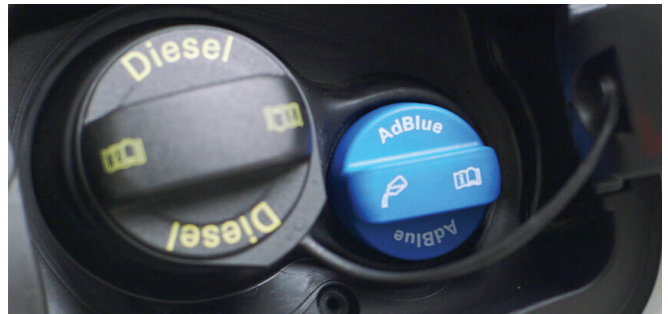
Slika 4 – Mjesto za dolijevanje AdBlue tekućine često se nalazi kraj otvora za dolijevanje goriva (izvor: www.uk.audi.com )
