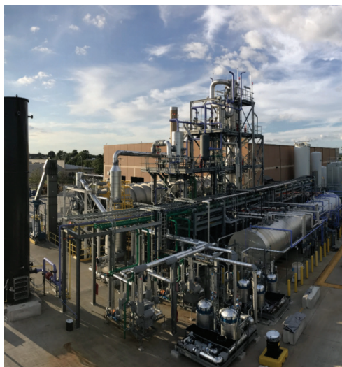
Slika 3 – Tvrtna Alterra među prvima je razvila i komercijalizirala tehnologiju kontinuiranog kemijskog recikliranja te pretvara plastiku namijenjenu odlagalištu natrag u petrokemijske proizvode. Ti se proizvodi mogu dalje rafinirati u goriva, voskove i nove sirovine za proizvodnju plastike. Alterrina tvornica u Akronu uspješno je komercijalizirala postrojenje koje, preusmjeravajući milijune kilograma plastičnog otpada s odlagališta otpada, proizvodi 60 t raznih proizvoda dnevno (izvor: https://alterraenergy.com/ ).
