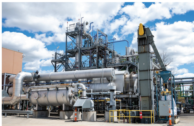
Slika 4 – Jedinica za pirolizu Alterrine tvornice u Akronu. Plastični otpad ulazi u procesor za predpirolizu, gdje se zagrijava, miješa s aditivom i zgusne. To osigurava dosljednu obradu otpadne plastike. Plastični otpad zagrijava se u odsutnosti kisika dok se ne razgradi u kondenzibilnu paru ugljikovodika i plin koji nije moguće kondenzirati. Alterrina jedinica za pirolizu osigurava predvidljive ishode postignute u kontroliranom okruženju reaktorskog sustava. Para ugljikovodika zatim se hladi u ukapljeni petrokemijski proizvod, koji se dalje može rafinirati u goriva, voskove i sirovine za novu proizvodnju plastike. Nekondenzirajući plin se vraća natrag u sustav za oporabu energije (izvor: https://alterraenergy.com/ ).
