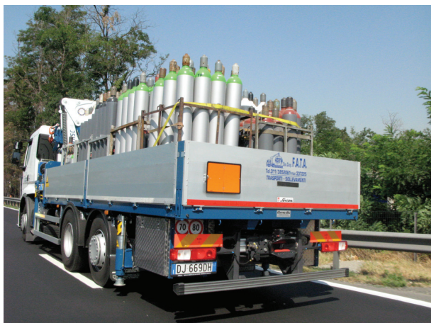
Slika 8 – Prijevoz plinskih boca. Vozilo sandučar je označeno praznom narančastom pločom (izvor: autorica).
