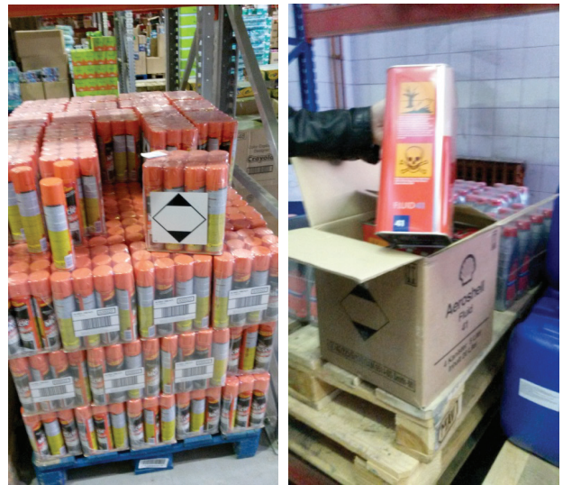
Slika 12 – Paketi zapakirani u "ograničenim količinama". Proizvodi koji u sebi imaju opasne kemikalije, ali upakirane tako da nema obveze pridržavanja odredbi ADR-a prilikom prijevoza. To se dokazuje stavljanjem pripadajuće listice (izvor: ZIRS d. o. o.).
