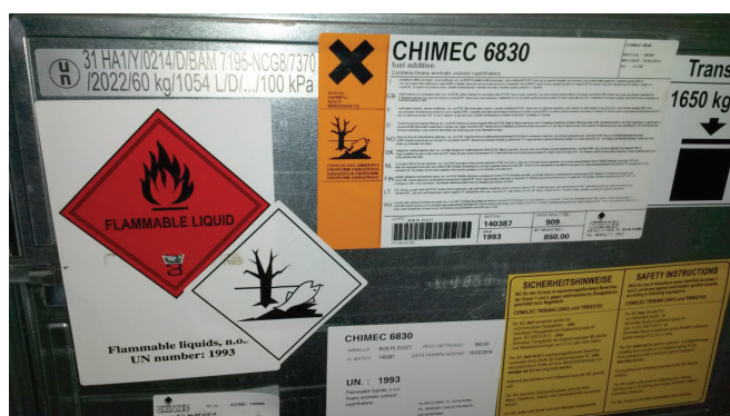
Slika 5 – Detalj s IBC-kontejnera. U gornjem lijevom uglu je certifikacijski kôd (izvor: ZIRS d. o. o.).
