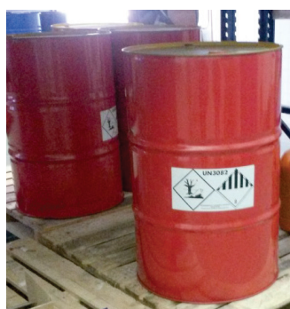
Slika 2 – Metalna bačva, UN broja 3082, TVARI OPASNE PO OKOLIŠ, TEKUĆINE N.D.N., Klasa 9
