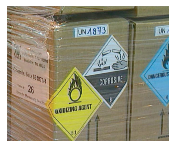
Slika 4 – Paket u kojem se nalazi UN 1873, PERKLORNA KISELINA, iz klase 5.1
