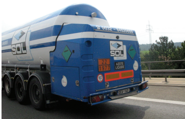
Slika 9 – Prijevoz duboko pothlađenog dušika UN 1977, klasa 2 plinovi u cisterni. Vozilo je označeno narančastom pločom s brojevima i listicom br. 2.2. (izvor: autorica).
