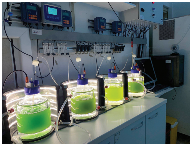
Slika 4 – Četiri serijski povezana fotobioreaktora. Temperatura, upuhivanje smjese zrak : CO 2 , pH, električna provodnost, intenzitet svjetlosti i dinamika osvjjetljenja "svjetlo:tama" upravljani su putem SCADA sustava (proizvela tvrtka CWT d. o. o.).
