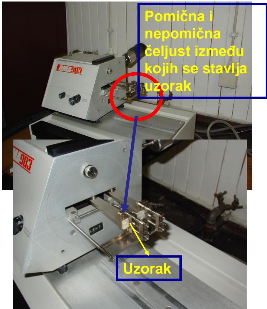
Prije mjeranja namjesti se temperturni interval u kojem se ispituje materijal, brzina zagrijavanja, frekvencija, amplituda i dimenzije uzorka.
