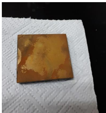
Slika 3.9 Laboratorijski dobivena hrđa na uzorcima metala
