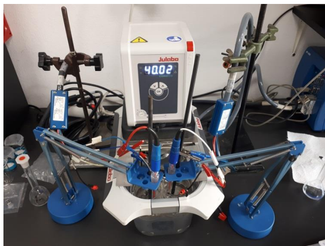
Slika 3.11 Ispitivanje u masi otopine elektrode s pločicom 1.9 x 1.9 cm pri povišenoj temperaturi
