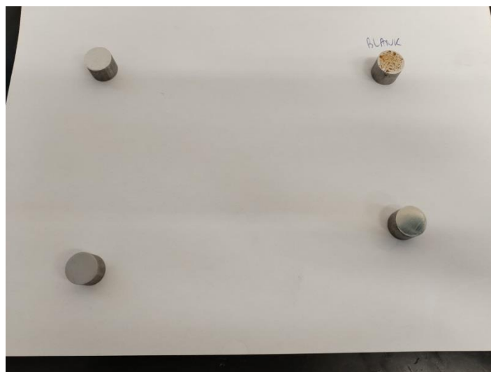
Slika 4.4 Izgled kupona čelika nakon djelovanja inhibitora A u kiseloj kiši
