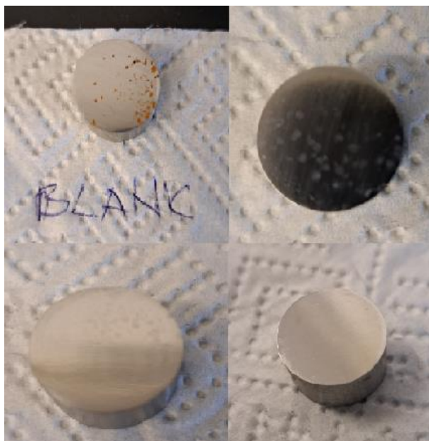
Slika 4.5 Izgled kupona čelika nakon djelovanja inhibitora A u 1% NaCl
