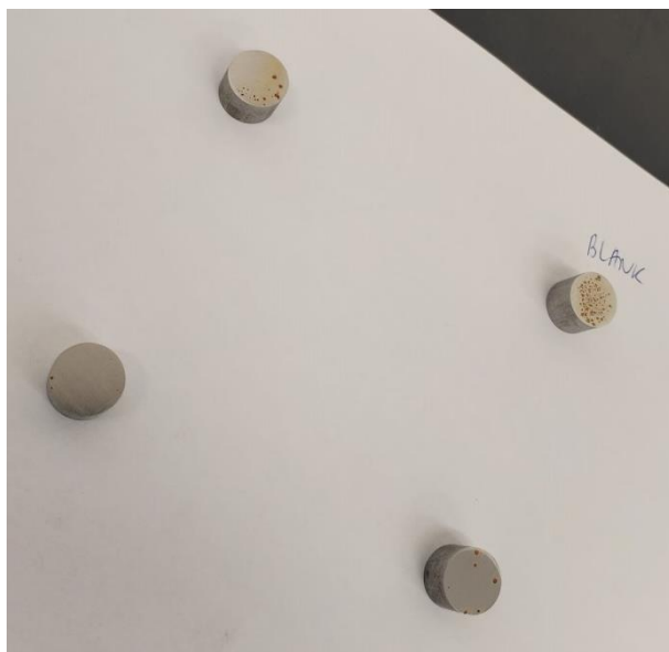
Slika 4.6 Izgled kupona čelika nakon djelovanja inhibitora B u kiseloj kiši
