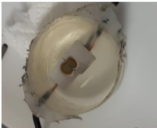
Slika 4.34 Prikaz diferencijalne aeracije na površini disk elektrode na rubovima kapljice
