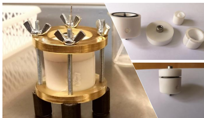
Slika 26. 2-elektrodna ćelija za elektrokemijska ispitivanja dizajnirana u Laboratoriju za molekulska fiziku i sinteze novih materijala, Instituta Ruđer Bošković
