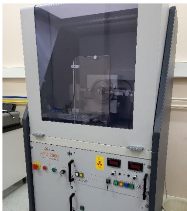
Slika 29. Difraktometar ItalStructures APD2000 dostupan u Zavodu za kemiju materijala na Institutu Ruđer Bošković
