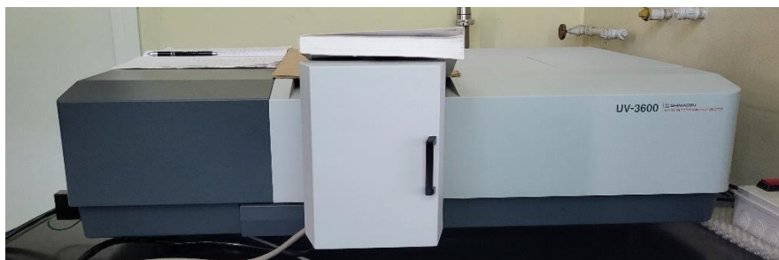
Slika. Shimadzu UV/VIS/NIR spektrometru, model UV-3600 dostupan u Zavodu za kemiju materijala na Institutu Ruđer Bošković
