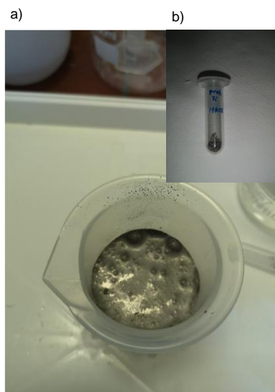
Slika 20. a) Proces jetkanja, b) konačni produkt, uzorak S3
