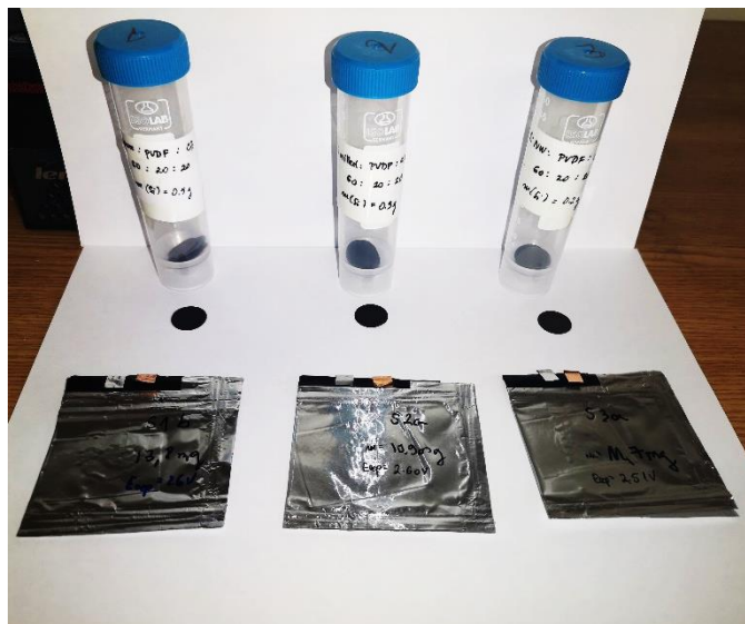
Slika 25. Pripremljene elektrode S1, S2 i S3 i pripadajući „coffee bag“ galvanski članci
