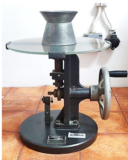
Slika 6. Potresni stol za ispitivanje konzistencije.
