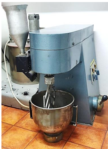
Slika 7. Mikser za pripremu morta zapremnine 5 L.
