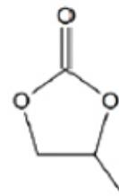
Ciklički karbonati (etilen-karbonat, propilen-karbonat)
