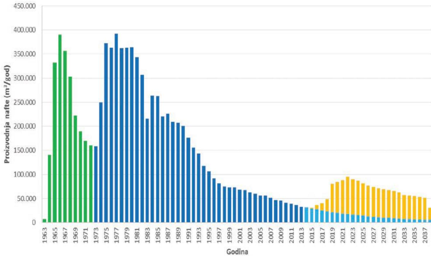
■ Primarna faza proizvodnje ■ Sekundarna faza proizvodnje ■ Nastavak sekundarne faze proizvodnje ■ Predviđanje tercijarne faze proizvodnje
