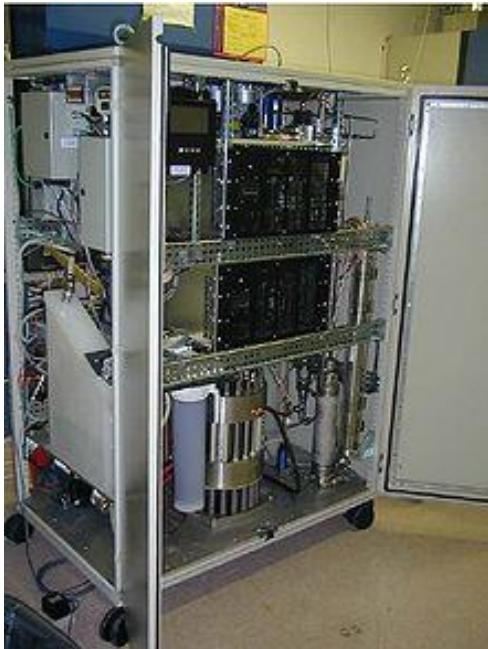
Visokotlačni PEM elektrolizer
