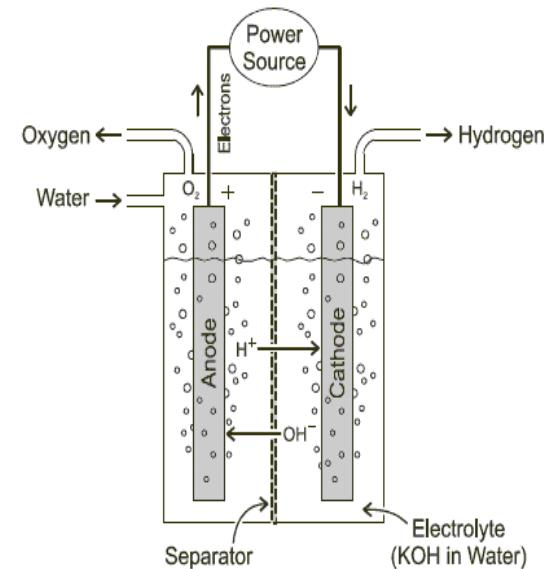
Elektroliza je elektrokemijski proces razdvajanja vode na vodik i kisik upotrebom električne energije. Zbog visoke cijene električne energije, učinkovitost je vrlo važan parametar kod elektrolize.
