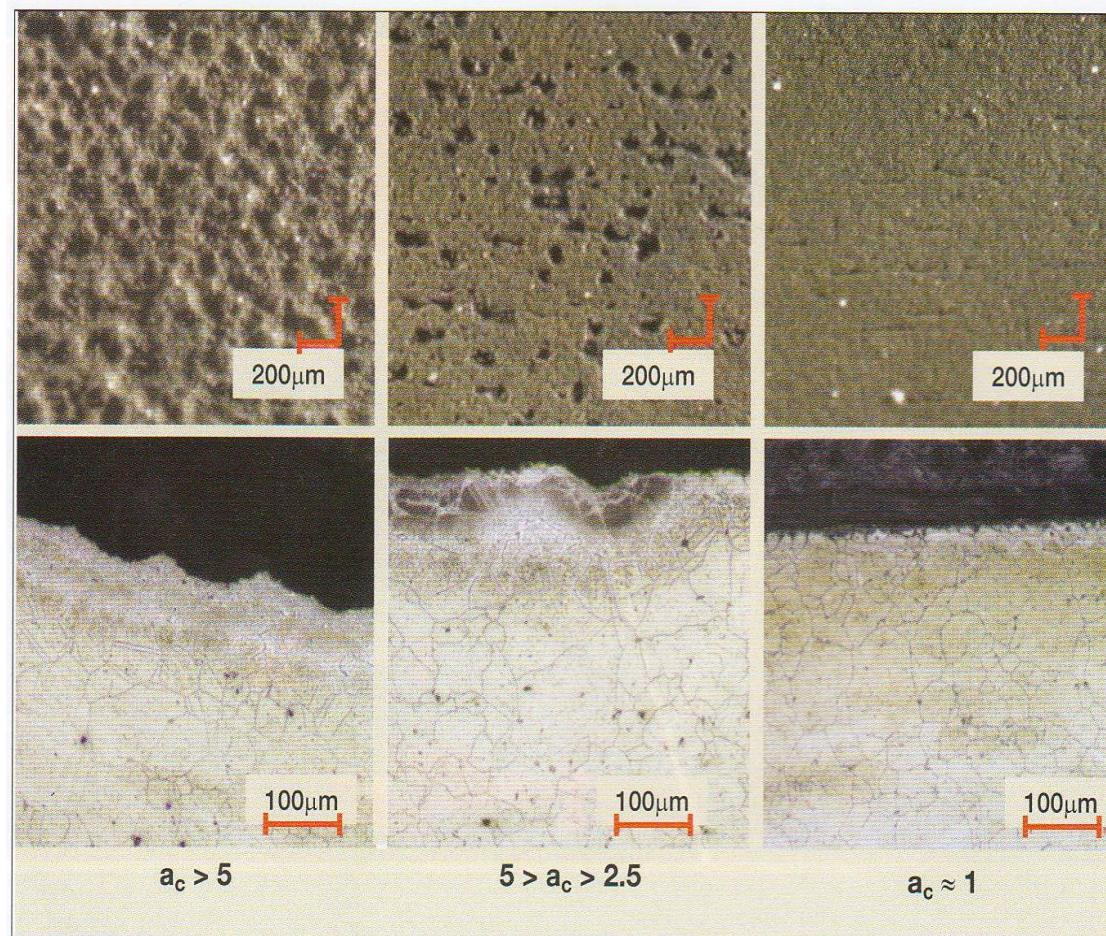
Prikaz morfologije unutarnje površine (gornje slike) i presjeci nakon jetkanja (donje slike) cijevi izrađenih od slabo otporne slitine nakon 8000 sati rada u uvjetima sklonim MD koroziji kao funkcija aktiviteta ugljika,  $a_c$ .
