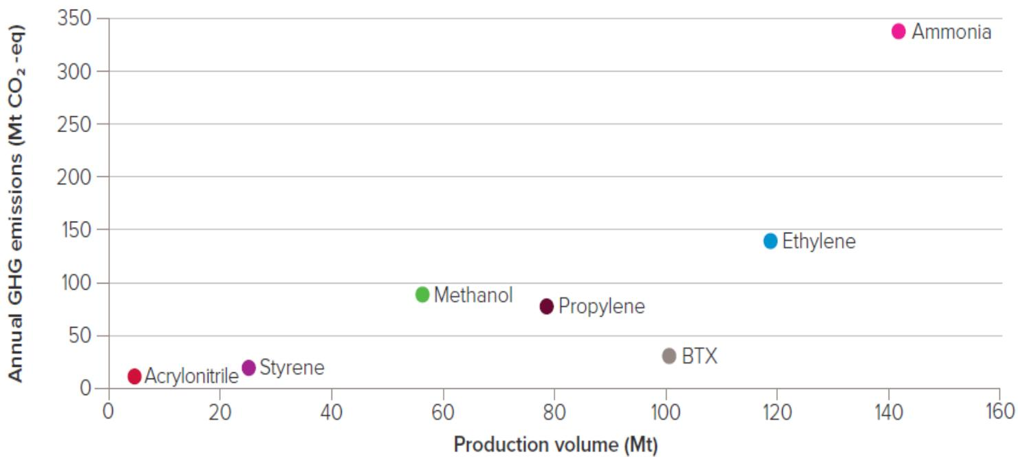
Emisije stakleničkih plinova u industrijskoj proizvodnji visoko volumnih kemikalija (podaci za 2010. godinu; BTX = benzen, toluen, ksilen – bazni aromatski ugljikovodici).
