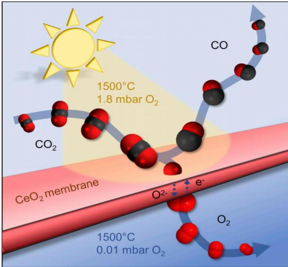
Konverzija  $\text{CO}_2$  u gorivo putem termokemijskog procesa na sunčevu zračenje - solarni reaktor kontinuirano cijepa  $\text{CO}_2$  preko redoks membrane u odvojene tokove  $\text{CO}$  i  $\text{O}_2$  pomoću koncentriranog sunčevog zračenja (solarni toranj).
