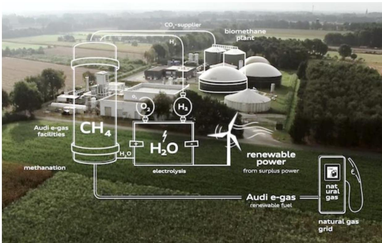
Tehnološka shema procesa proizvodnje sintetskog metana
