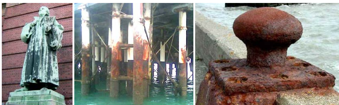
Slika 1. Različiti predmeti koji korodiraju u urbanim i morskim atmosferama.
