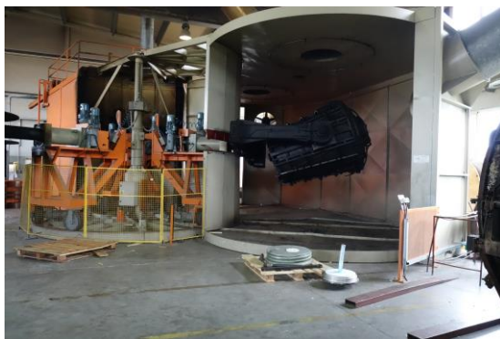
Slika 50. Shematski prikaz a) kalupa za rotacijsko kalupljenje vinilnih disperzija i b) plastomera, fotografija proizvodnje plastičnog kontejnera rotacijskim lijevanjem
