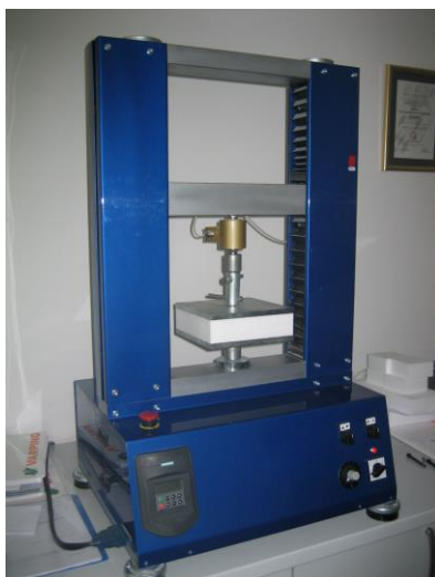
Slika 79. Ispitivanje tlačne čvrstoće EPS
