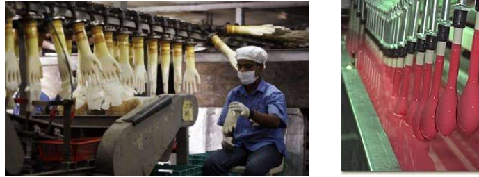
Slika 57. Fotografije automatske linije za proizvodnju rukavica i balona uranjanjem
