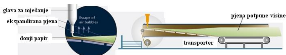
Slika 72. Shematski prikaz MAXFOAM postupka
