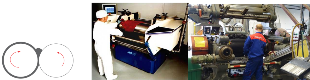
Slika 14 . Shematski prikaz dvovaljka a) i b) fotografije rada na dvovaljku
