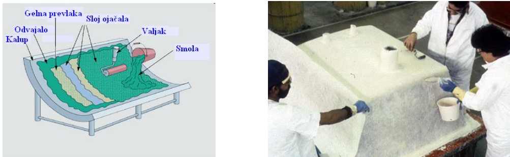
Slika 58. Prikaz dodirnog ručnog laminiranja
