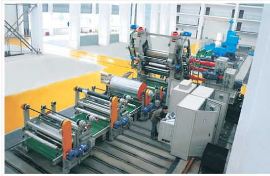
Slika 19 .Prikaz linije za kalandriranje
