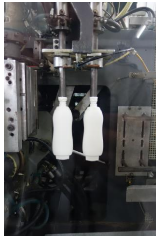
Slika 46. Shematski prikaz i fotografija ekstruzijskog puhanja
