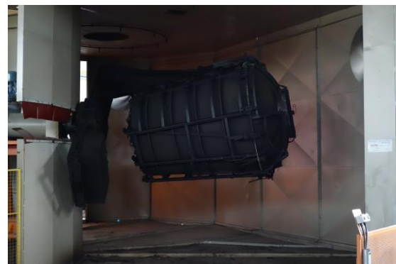
Slika 50. Shematski prikaz a) kalupa za rotacijsko kalupljenje vinilnih disperzija i b) plastomera, fotografija proizvodnje plastičnog kontejnera rotacijskim lijevanjem
