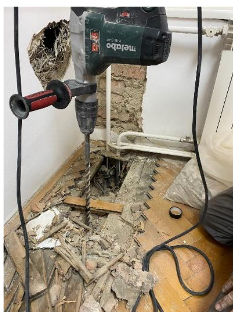
Slika 47 Određivanje debljine slojeva na poziciji K3
