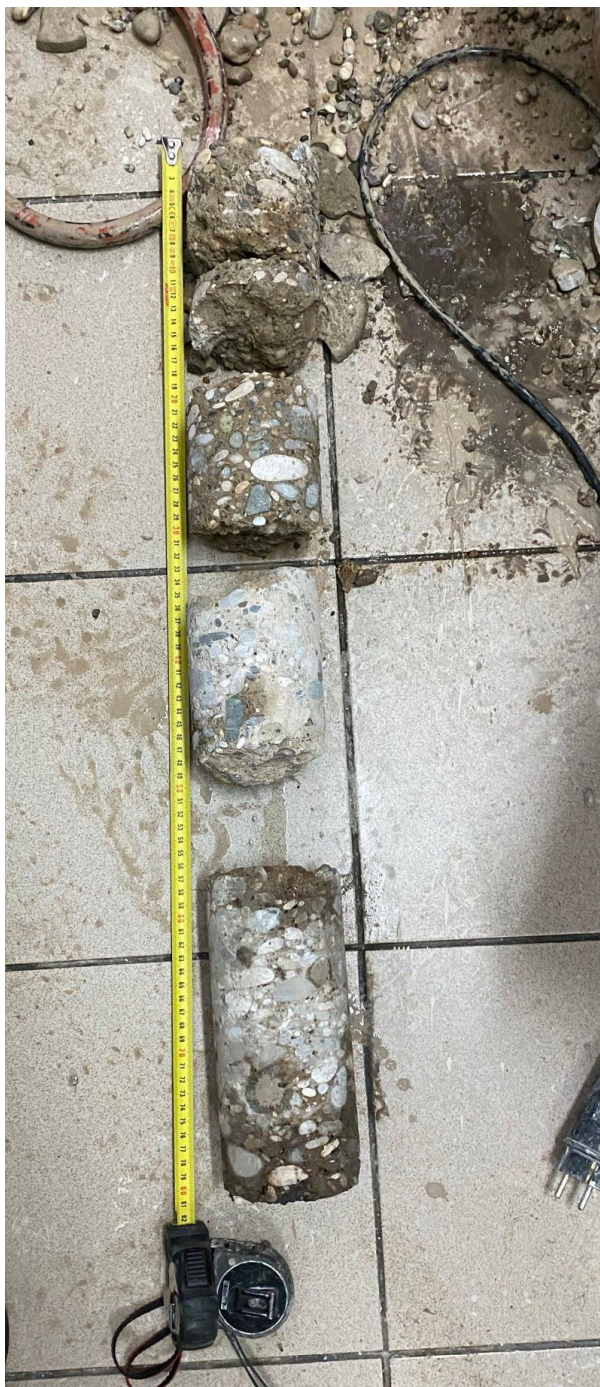
Slika 8 Izbušeni uzorak temelja
