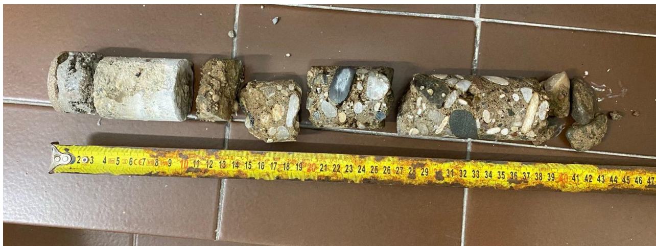
Slika 2 Uzorak iz temelja na poziciji 1
