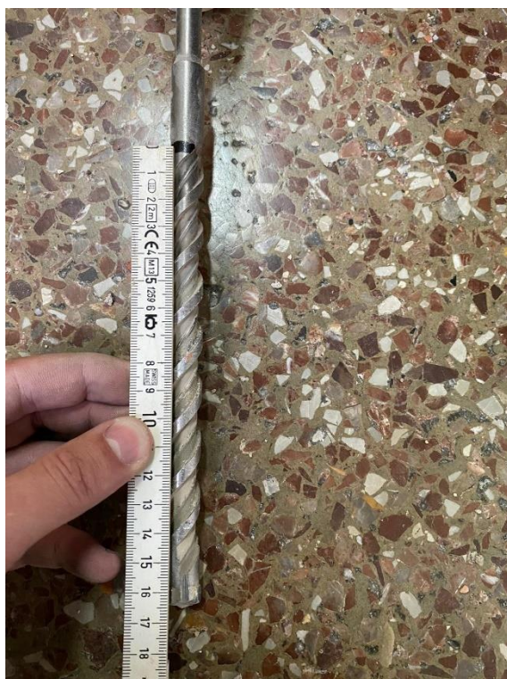
Slika 22 Određena debljina stropne ploče na poziciji S6
