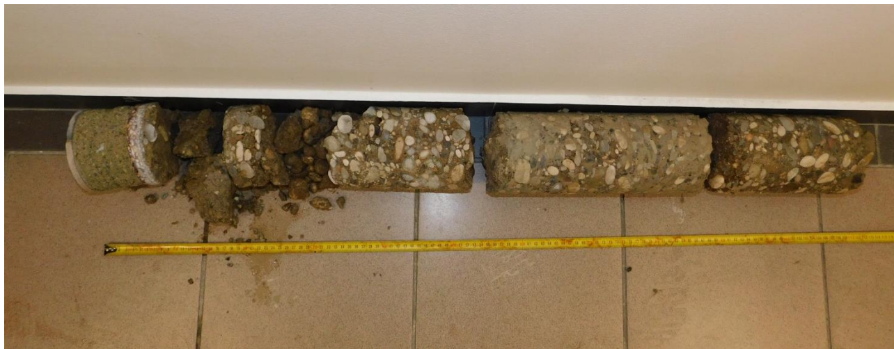
Slika 5 Uzorak iz temelja na poziciji 2
