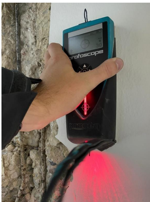
Slika 21 Određivanje pozicija armature tragačem na poziciji S6
