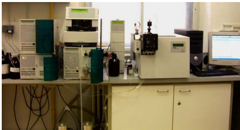
Slika 2. Uređaj za tekućinsku kromatografiju visoke djelotvornosti (Varian ProStar 500) korišten u laboratorijskom radu
