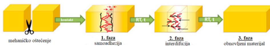
Slika 4 – Shematski prikaz samoobnove vitrimera nakon mehaničkog oštećenja
