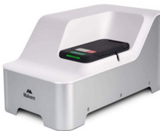
Slika 2 – Uređaj koji se koristi prilikom provođenja vježbališta – Malvern Zetasizer Ultra
