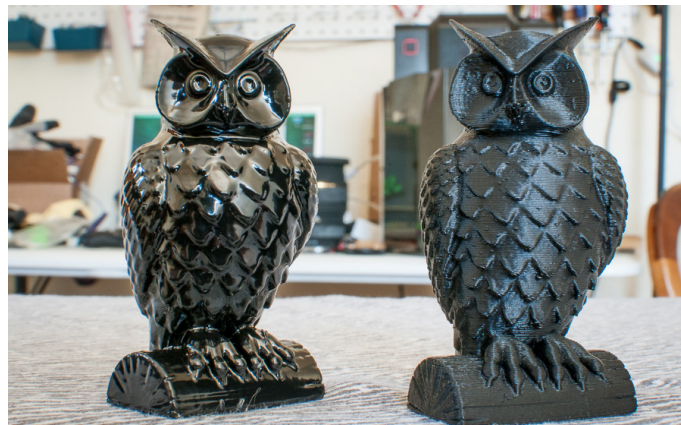
Slika 3 – Prikaz predmeta izrađenog FDM-om nakon i prije provedenog postupka zaglađivanja parama otapala
