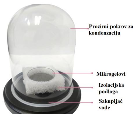
Slika 2 – Prototip uređaja za proizvodnju vode iz zraka 3
