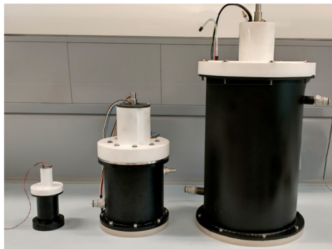
Slika 1 – Elektrokemijski reaktori s cilindričnom elektrodom korišteni za sintezu u većem mjerilu. S lijeva na desno: 58 ml, 250 ml i 1,25 l
