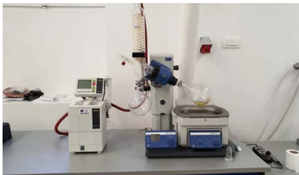
Slika 2. Sustav za pripremu otapala: vakuumska pumpa spaja se na rotacijski isparivač čime cijeli sustav funkcionira kao rotacijski vakuumski isparivač (rotavapor). Koristi se za pripremu niskotemperaturnih eutektičkih otapala koja se upotrebljavaju za pročišćavanje sirovina i sirovog biodizela.
