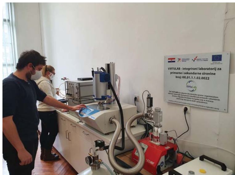
Slika 2. Diferencijalni pretražni kalorimetar s dvije peći i ukupnim radnim područjem od -150 do 1600 °C, njemačkoga proizvođača Linseis GmbH, model HDSX-PT 1600, instaliran u jednom od laboratorija Zavoda za anorgansku kemijsku tehnologiju i nemetale.
