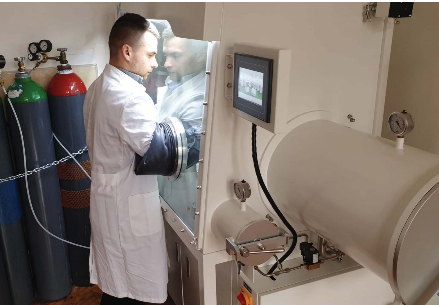
Slika 1. Grgur Mihalinec, mag. appl. chem., za vrijeme izrade baterijskog članka u komori s inertnom atmosferom.
