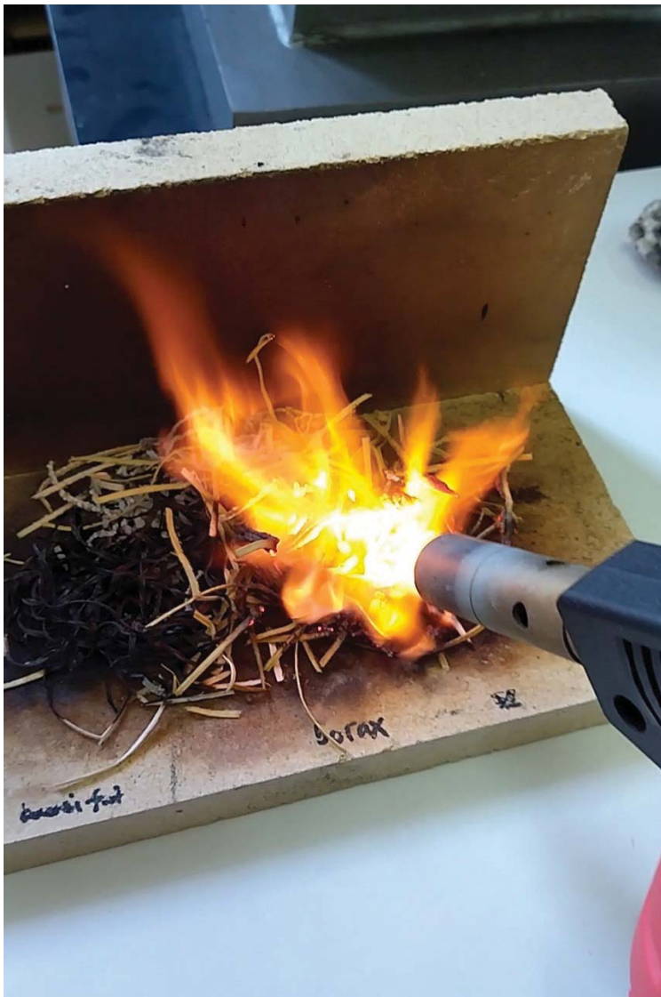
Slika 3. Laboratorijsko ispitivanje aditiva protiv gorenja drvene vune.
