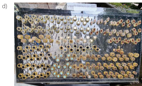
Slika 1. Provedba elektrokemijskih ispitivanja (a i b) na brončanoj skulpturi (c) te slika laboratorijskih uzoraka patine (d) i njihove karakterizacije FTIR spektroskopijom (e).
