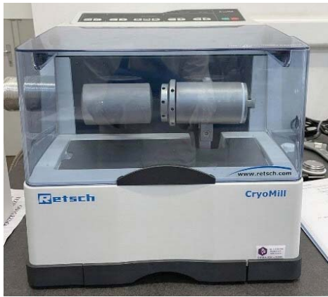
Slika 1. Kuglični kriomlin za pripremu mikroplastike usitnjavanjem uzoraka nestarene i starene plastike.
