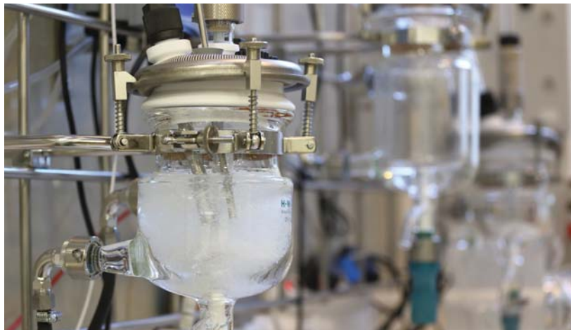
Slika 3. Šaržni kristalizator s PAT sondama.
