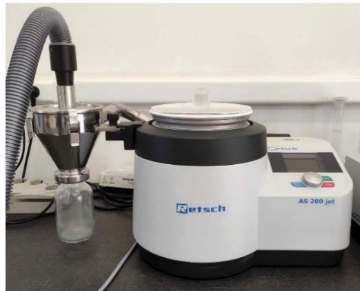
Slika 2. Laboratorijsko sito sa zračnim mlazom za razdvajanje čestica mikroplastike prema veličini.
