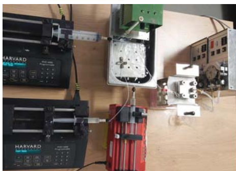
Slika 2. Shematski prikaz integriranog mikrosustava za proizvodnju i pročišćavanje biodizela ultrafiltracijom.
