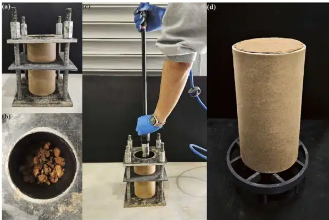
Slika 3 – Izrada CCRE cilindara: (a) nosači za učvršćivanje kartonske cijevi, (b) kartonska cijev ispunjena rastresitom mješavinom tla izoliranom polietilenskom folijom, (c) zbijanje s pomoću pneumatskog nabijača, (d) skladištenje izrađenog CCRE cilindra na šupljem nosaču tijekom 28 dana sušenja
