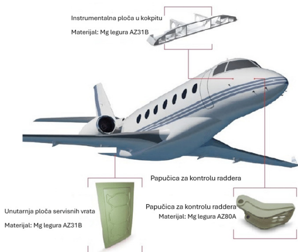
Slika 3 – Primjeri gdje se još nalaze magnezijske legure kod zrakoplova, što pokazuje koliko su odlična i primjenjiva 6
