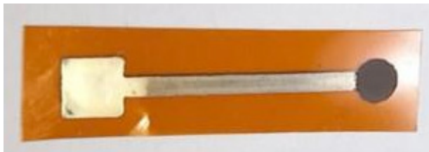
Slika 2 – Inkjet ispisana referentna Ag/AgCl elektroda 5
