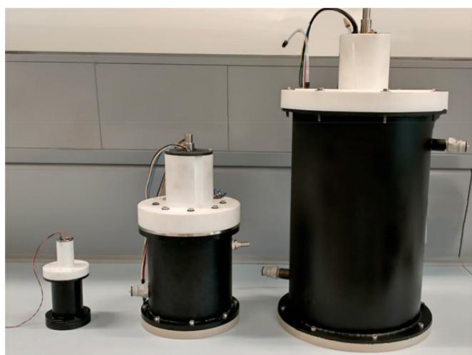
Slika 1 – Elektrokemijski reaktori s cilindričnom elektrodom korišteni za sintezu u većem mjerilu.
