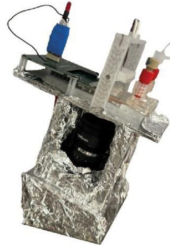
Slika 4 – MEA postav: B – bočni pogled s kamerom i C – prednji s mikrofluidnim sustavom
